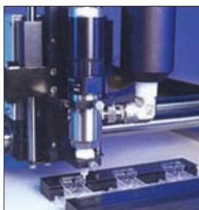
**Рис.4. Поршневая дозирующая головка**
