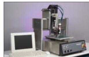
**Рис.7. Автомат дозирования серии DispenseMate 550**
