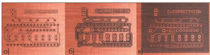
**Рис.2. Возможные варианты гравировки проводников при расчете траекторий гравировки: а) гравирование только изоляционных каналов; б) частичное снятие меди в ответственных местах; в) полное снятие меди**
