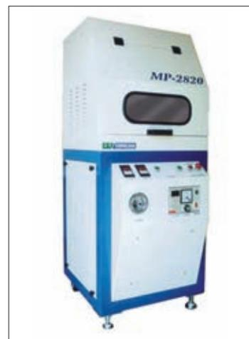
**Рис.4. Пресс MP2820 для изготовления многослойных печатных плат**
