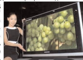
Рис.5. Опытная панель на органических светодиодах с диагональю 40" компании Samsung SDI. Пока ее цветовая гамма (80% NTSC) несколько меньше, чем у ЖКД, но по быстродействию она превосходит ЖКД в 100 раз
