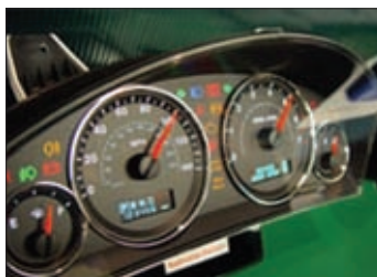
Рис.4. OLED-модули компании Optrex America в приборной панели автомобиля
