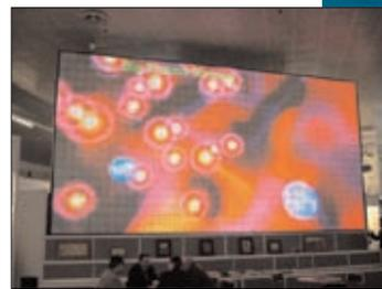
**Рис.3. Плазменный наборный экран размером 8х4 м с шагом пиксела 12 мм**
