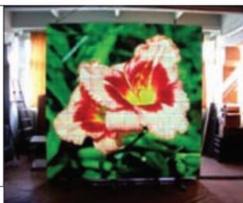
**Рис. 7. Плазменный полноцветный модульный (наборный) экран**
