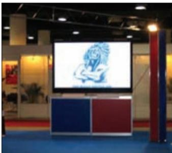
**Рис.2. Светодиодный экран размером 2х1,2 м с шагом пиксела 6 мм**
