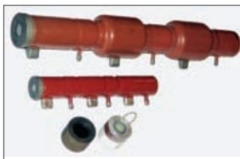
**Рис. 1. Многокаскадные ЭОП с мультищелочными фотокатадами, выпускавшиеся в 60-е годы прошлого века (два верхних) и современные ЭОП третьего поколения с GaAs-фотокатадами диаметром 25 и 18 мм (нижний ряд)**
