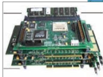
Рис.6. Установка плат ускорителя в стек при внешнем подключении
