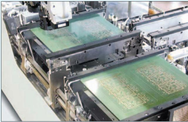
**Рис.1. Современное оборудование сборки на крупных ПП**
