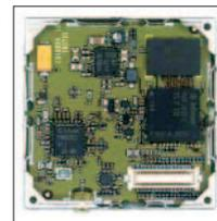
**Рис.2. Модем семейства GM862 фирмы DAI Telecom**
