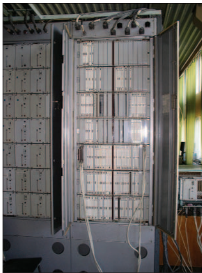
Рис.6. Одна из конфигураций КВС "Связь-М" – СУВК-СМ (СУВК-СМ – справа, слева – телефонные коммутаторы)
