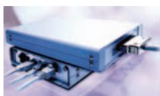
В новом средстве периферийного сканирования DataBlaster JT 37x7/TSI фирмы JTAG Technologies возможен выбор интерфейса – USB 2.0 (и 1.1), Ethernet или FireWire. Предлагаемый
