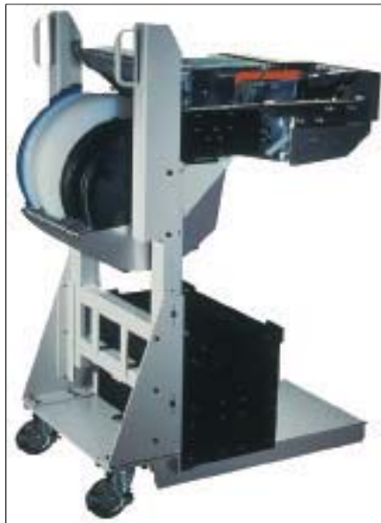
Рис.9. Мобильная система смены питателей рот компонента на угол установки перед распознаванием. Точность установки компонентов в этом случае составляет \pm 35 мкм ( 3\sigma ). Автоматы серии X II снабжены взаимозаменяемыми питателями – ленточными, вибропитателями, питателями для россыпи, питателями из матричных поддонов. Пневмомеханические питатели совместимы с предыдущими моделями автоматов. Электронные питатели ИТF-типа сов-
