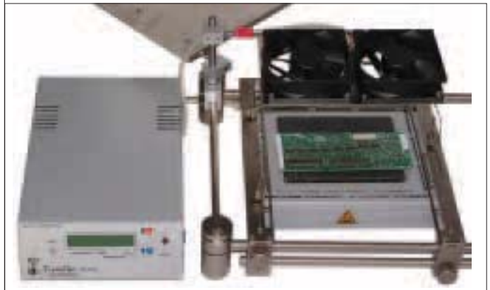
Рис.6. Установка для пайки по термопрофилю
