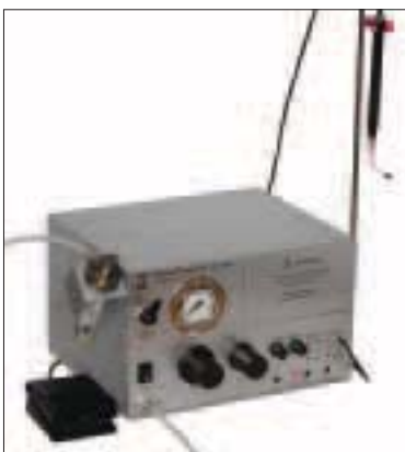
Рис.2. Вакуумный манипулятор ВМ-01 с набором инструментов
