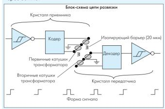
Цепь развязки (iCoupler) содержит два отдельных кристалла – передатчик и приемник, упакованные в один прибор. Трансформатор прибора состоит из двух пар катушек, разделенных 20-мкм твердотельным изолирующим барьером (см.рис.). Планарная структура, которая образует первичные катушки, помещена вертикально над структурой вторичных катушек.
