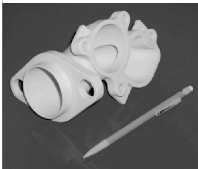
Рис.9. Кронштейн трубопровода, "напечатанный" трехмерным фаббером фирмы Z Corp.
