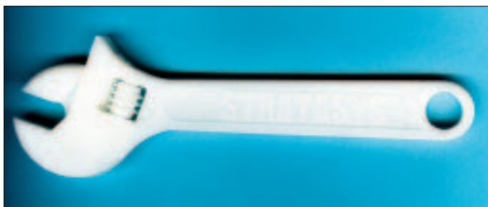
Рис.4. Образец ключа из СБА-пластмассы, изготовленный на установке FDM-3000
