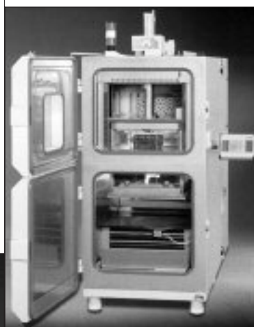
Рис.6. Шоковая температурная камера с двумя зонами
