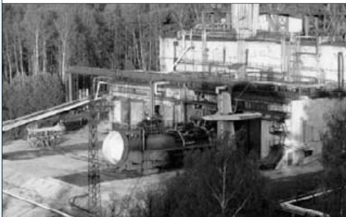
Рис.1. Огневые испытания реактивного двигателя на стенде НИИХИММАШ
