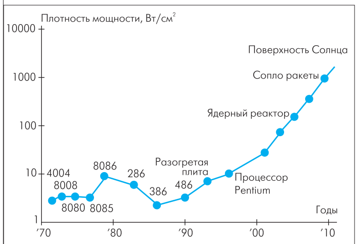
Рис. 1. Увеличение плотности потребляемой микропроцессором мощности
