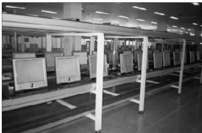
Рис.5. Готовые ЖК-мониторы. Разные цвета защитных пленок на поверхности экрана соответствуют участку сборки или сборщику
