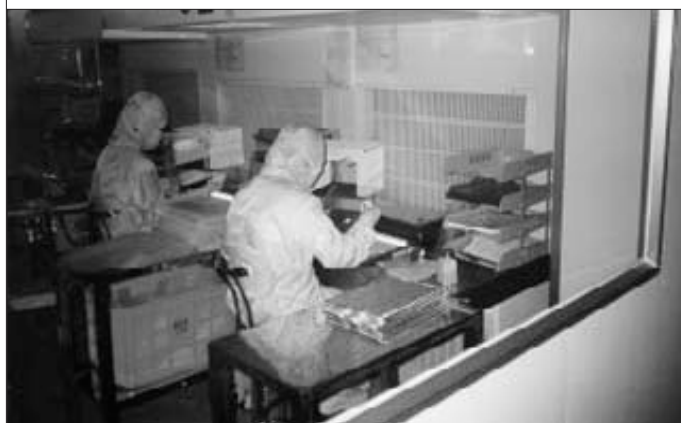
Рис.4. Это не кадр из сериала "За стеклом". Участок отбраковки и очистки пластин
