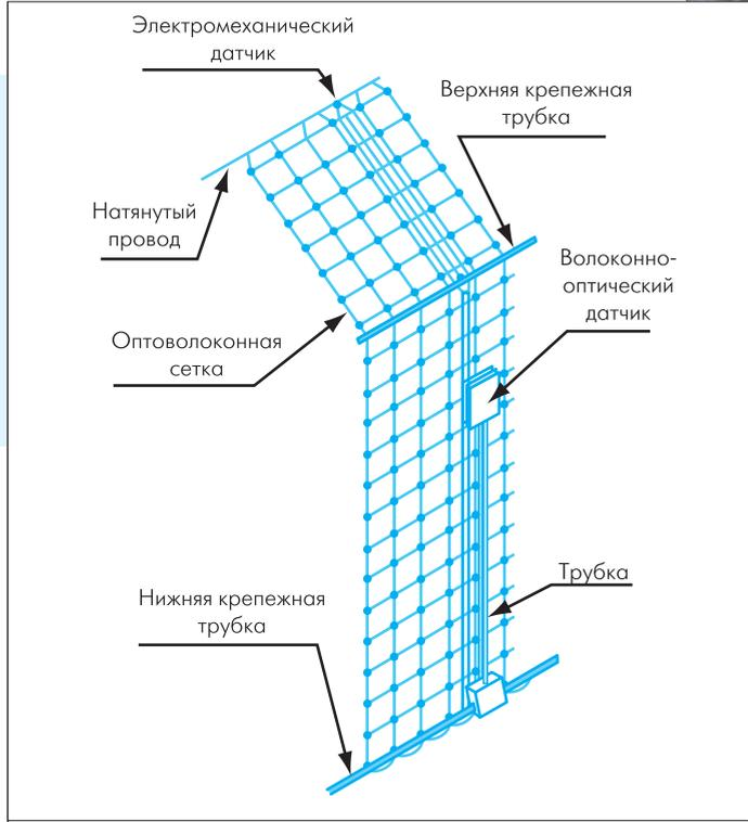
Рис.7. Система FiberMESH 2005
