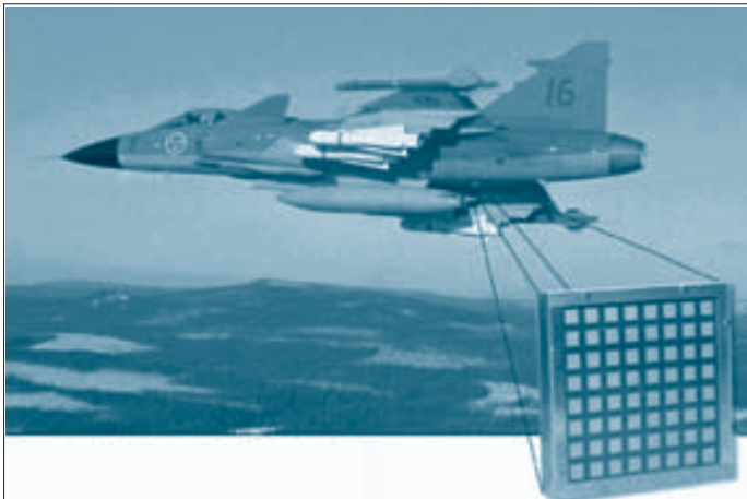
Рис. 12. Шведская концепция бортовой многофункциональной РЛС с ЦАР
