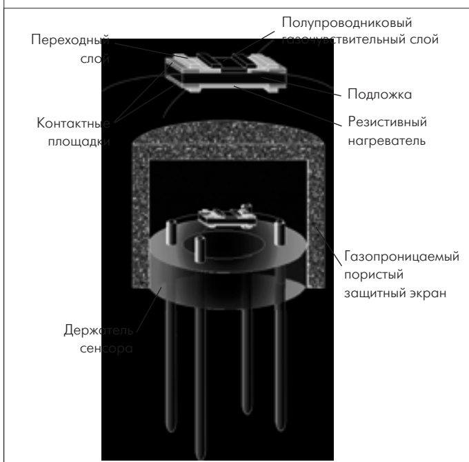
Рис. 1. Устройство металлооксидного сенсора
