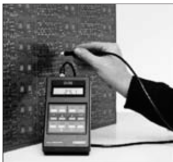
Рис.1. Медеизмеритель СМП1А в действии
