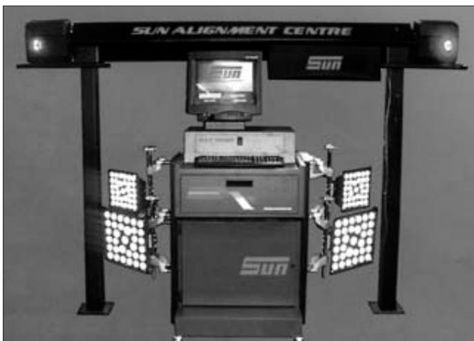
**Стенд проверки углов установки колес Sun SAC-4000**
