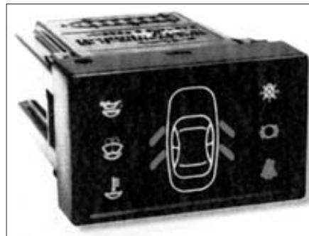
**Блок индикации бортовой системы контроля 12.3860**
