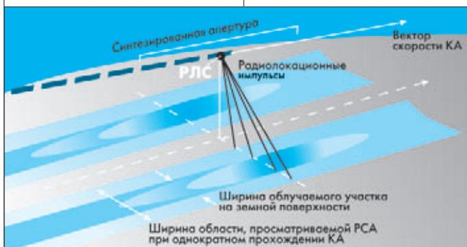
Рис. 1. Принцип работы РСА, расположенной на космическом аппарате
