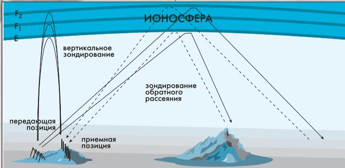
Рис.3. Вертикальное зондирование и зондирование обратного рассеяния в ЗГ РЛС
