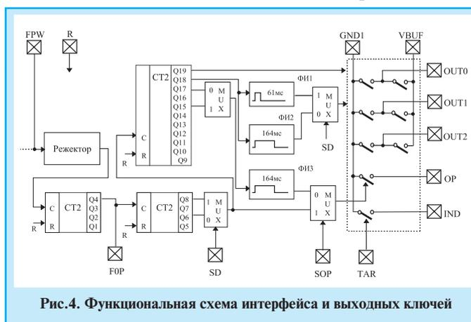
Рис.4. Функциональная схема интерфейса и выходных ключей
