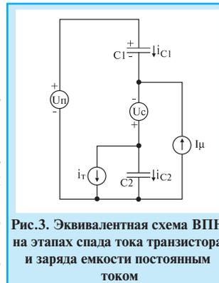
Рис.3. Эквивалентная схема ВПН на этапах спада тока транзистора и заряда емкости постоянным током
