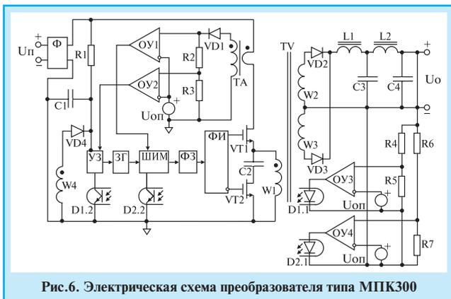
Рис.6. Электрическая схема преобразователя типа МПК300
