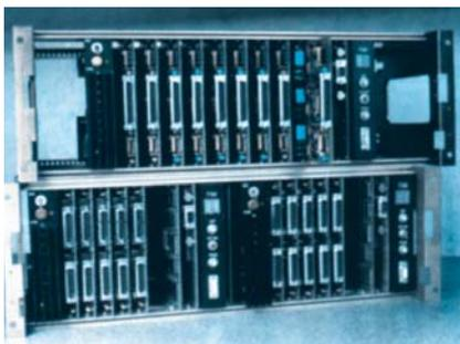
щий собой эффективное решение проблем взаимодействия цифровых систем коммутации и передачи с существующей аналоговой телефонной сетью. Надежный, компактный, простой в обслуживании АЦП, основанный на современной элементной базе, поддерживает большое число систем сигнализации и уже используется на ТФОП и ведомственных сетях во многих регионах России и СНГ.
