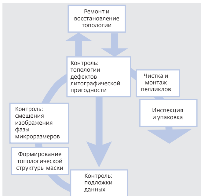
Рис.6. Технологический процесс производства фотошаблона
