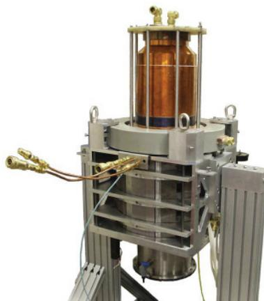
**Рис.8.** 18-лучевой клистрон S-диапазона лаборатории NRL в испытательном стенде
