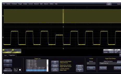
**Рис.6.** TriggerScan – режим обнаружения редких событий в высокочастотном сигнале
