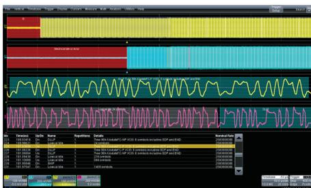
**Рис.5.** Приложение ProtoSync для декодирования протоколов последовательной передачи данных
