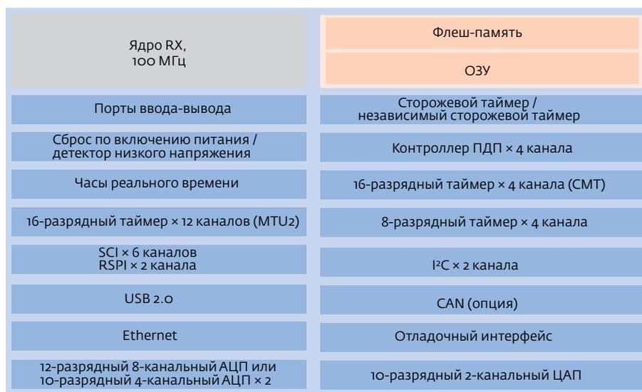
Рис.3. Блок-схема микроконтроллеров серии RX62N
