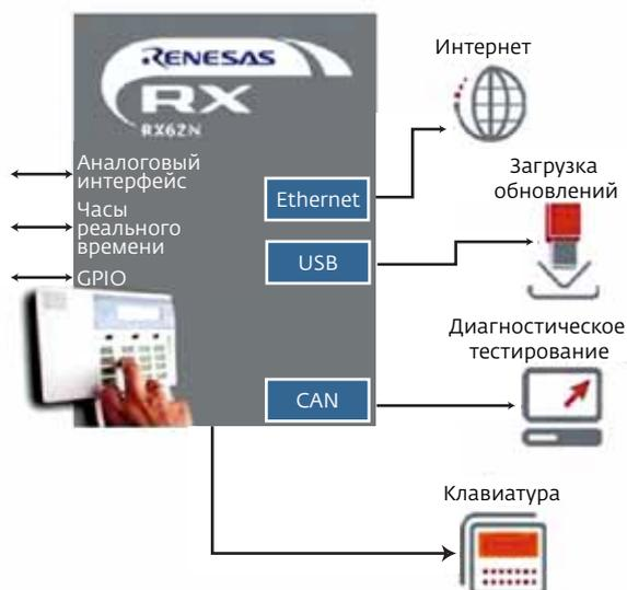
Рис.4. Примеры использования микроконтроллеров RX62N
