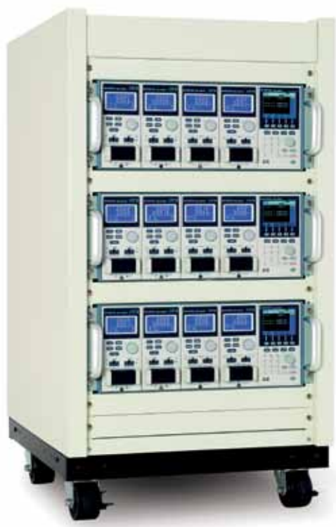
Рис.2. Объединение нескольких нагрузок для совместной работы в одной приборной стойке
