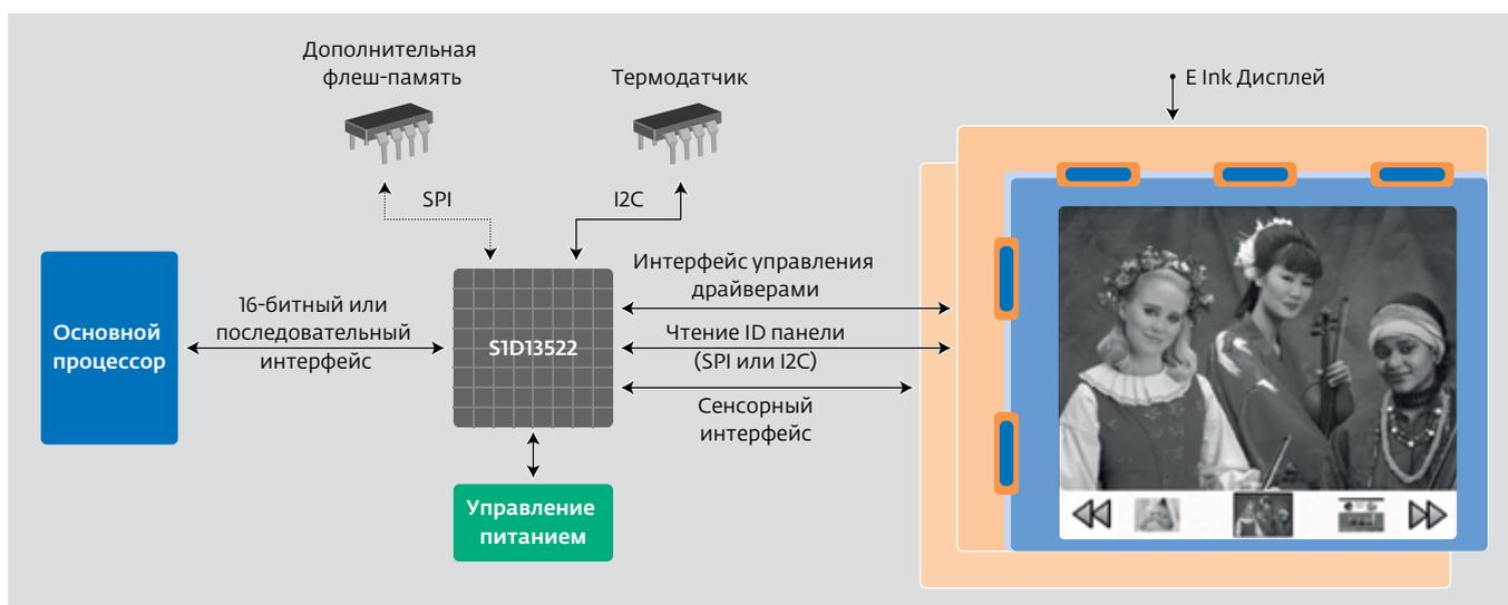
Рис.2. Структурная схема контроллера S1D13522
