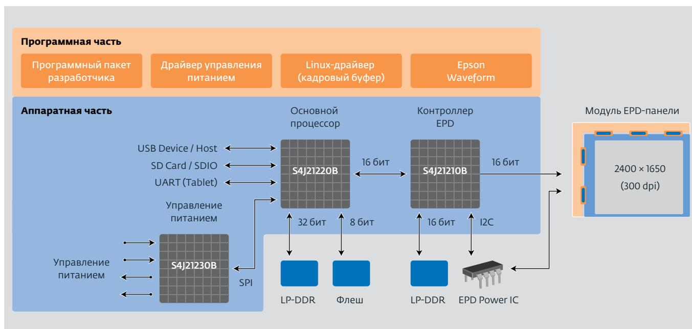
Рис.5. Структурная схема S4J21010 Evaluation Platform
