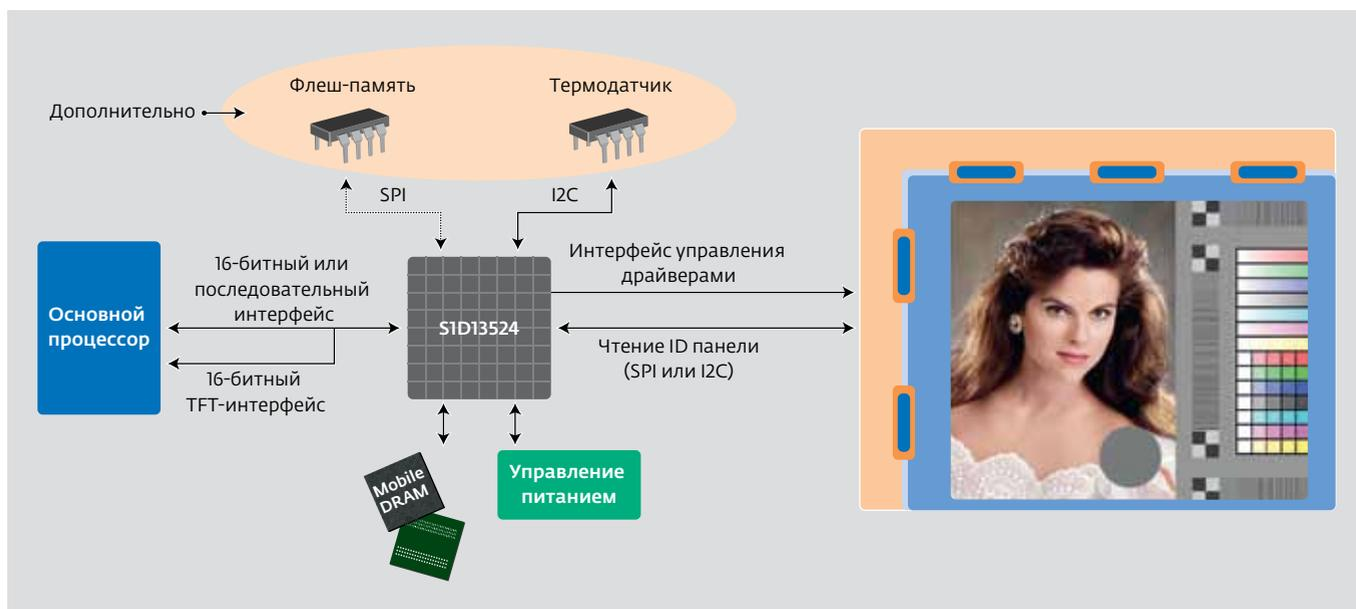
Рис.3. Структурная схема контроллера SID13524
