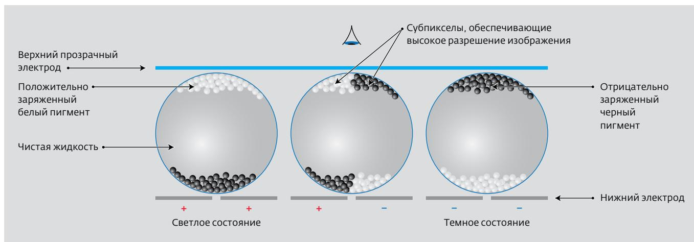
Рис.1. Структура модуля E-ink
