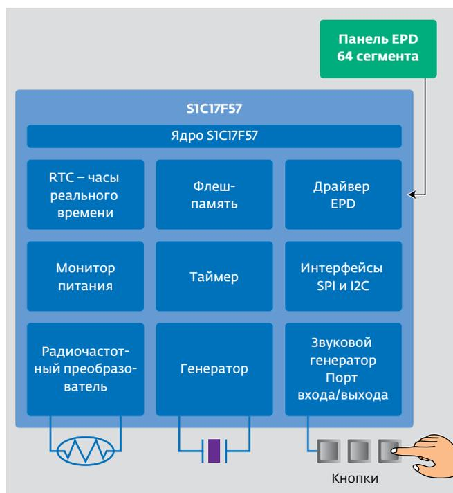
Рис.4. Структурная схема микроконтроллера S1C17F57
