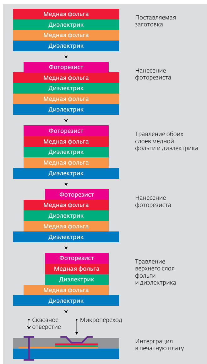
Рис.12. Схема процесса встраивания керамических тонкопленочных конденсаторов (ф. IPC)
