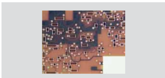
Рис.4. Слой печатной платы с 56 встроенными резисторами, нанесенными трафаретной печатью (ф. IPC)
