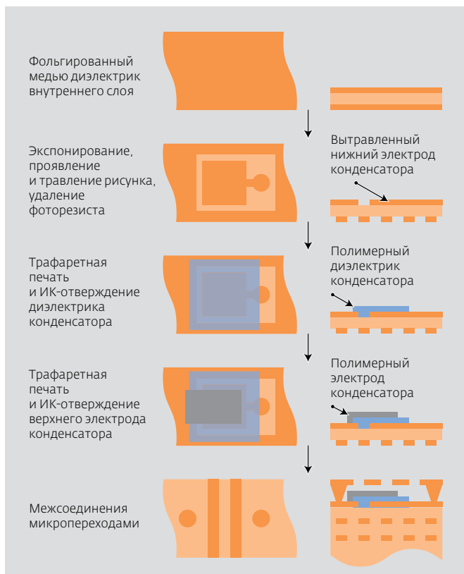
Рис.10. Схема процесса встраивания полимерных толстопленочных конденсаторов (ф. IPC)
