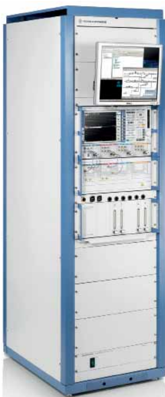
Рис.4. Система тестирования приемопередающих модулей АФАР TS6710
