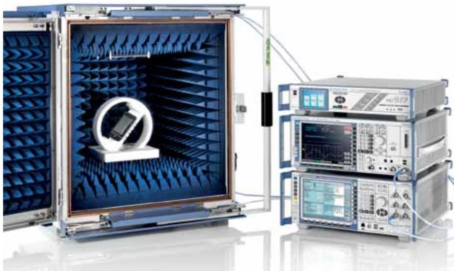
с широкополосным радиокommunikационным тестером R&S CMW500, который генерирует сигналы стандарта LTE, новое решение для измерения RSE гармонично
