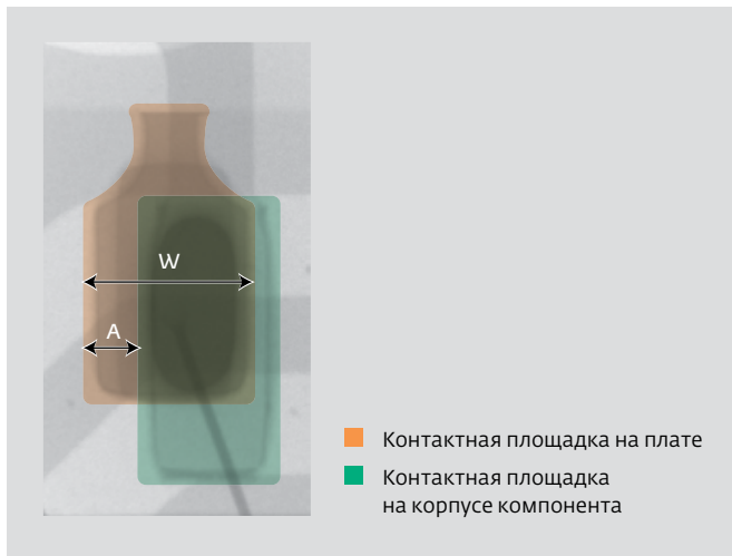
Рис.12. Рентгеновский снимок паяного соединения компонента QFN. Боковое смещение (A) составляет примерно 1/3 ширины контактной площадки на корпусе (W). Дефект для изделий класса 2 и 3, допустимо для изделий класса 1
