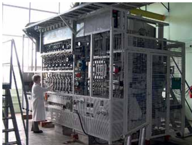
Рис.2. Линия пиролиза для танталовых чип-конденсаторов
