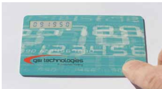
Рис.13. Кредитная карта со встроенным гибким печатным экраном для отображения одноразовых паролей [5]
