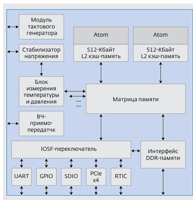
Рис.3. Блок-схема системы на кристалле, объединяющей Atom-процессор и WiFi-модуль
