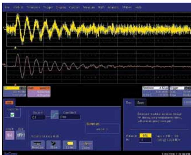
**Рис.3.** Результаты применения фильтрации (сигнал тот же, что на рис.2). Нижняя развертка представляет однократный сбор данных без усреднения. Фильтр удаляет шум свыше 8 МГц – как реальный, являющийся частью сигнала, так и приобретенный в процессе сбора данных
