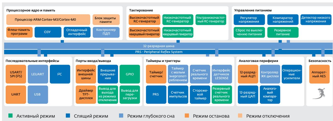
Рис.1. Блок-схема микроконтроллеров EFM32
