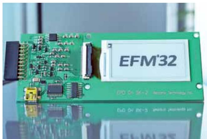
Рис.6. Модуль с дисплеем на основе "электронной бумаги"
