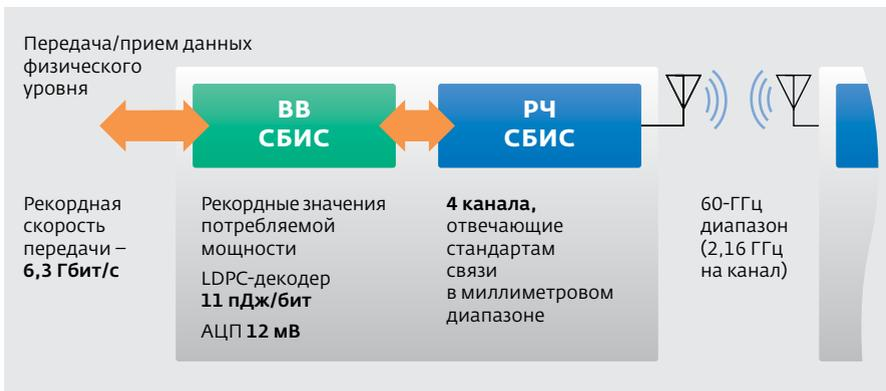
Рис.2. Блок-схема системы беспроводной связи в диапазоне 60 ГГц
