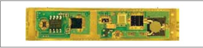
**Рис.4.** Приемопередающий модуль АФАР Х-диапазона
