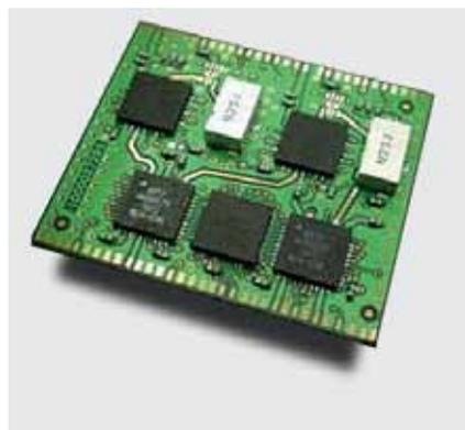
Рис.2. Недорогой приемопередающий модуль АФАР S-диапазона в сборке
