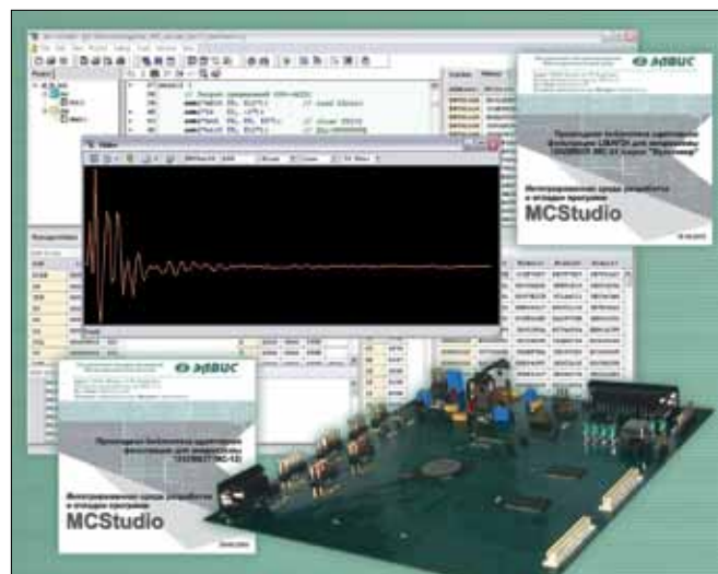
Рис.14. Прикладные библиотеки алгоритмов адаптивной фильтрации для ЦСП серии "Мультикор"
