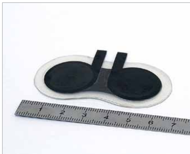
Рис.8. Печатная гибкая батарейка на 3 В [5]
