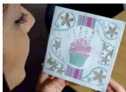
Рис.3. Поздравительная открытка со светодиодами и печатными батарейками для их питания. Когда именинник задувает "свечи", светодиоды гаснут [3]
