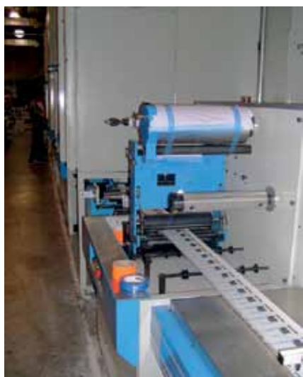
Рис.5. Рулонная печать батареек
