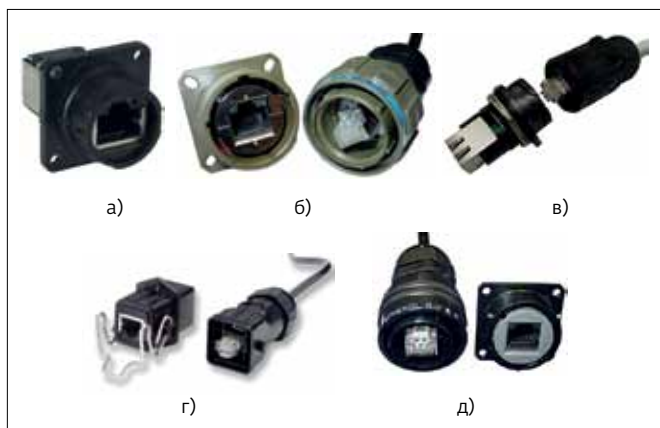
Рис.2. Виды соединителей: а – RJF 544 серия, пластиковый корпус, соединение push-pull; б – RJF TV серия, металлический корпус, соединение резьбовое; в – RJF RB серия, пластиковый корпус, соединение обратный байонет; г – RJF EZ серия, пластиковый корпус, соединение рычажное; д – RJF серия, металлический корпус, соединение обратный байонет
