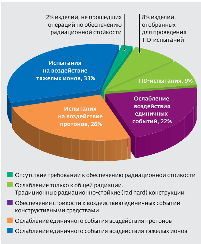
Рис.2. Сравнительные значения стоимости конструирования системы применительно к уровням обеспечения радиационной стойкости
