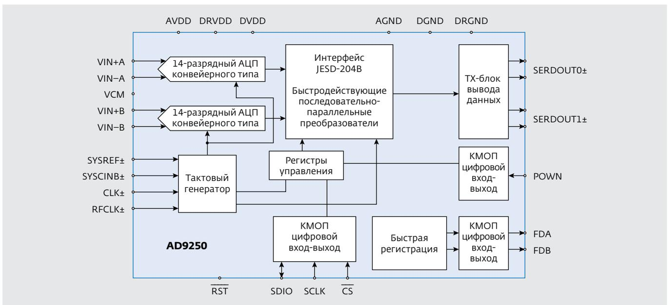
Рис.7. Функциональная блок-схема АЦП AD9250
